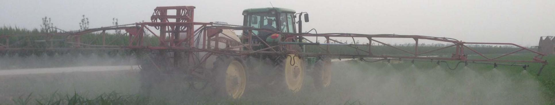
**Si el equipo aplica demasiado alto, y no se compensa con el ángulo de aspersión de las boquillas utilizadas, el resultado es una cobertura y dosificación completamente erróneas**
